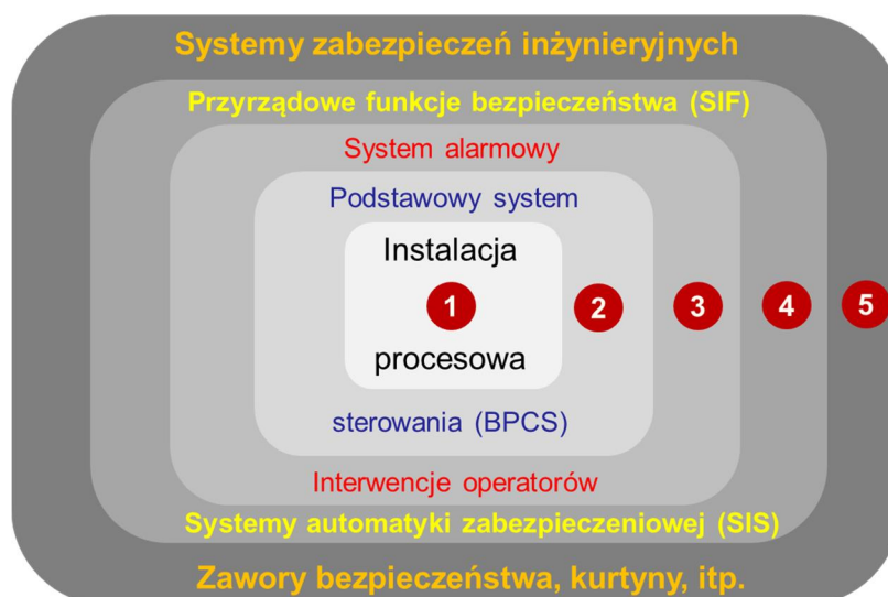
Rys.5. Warstwy zabezpieczeń (PN-EN 61511)
