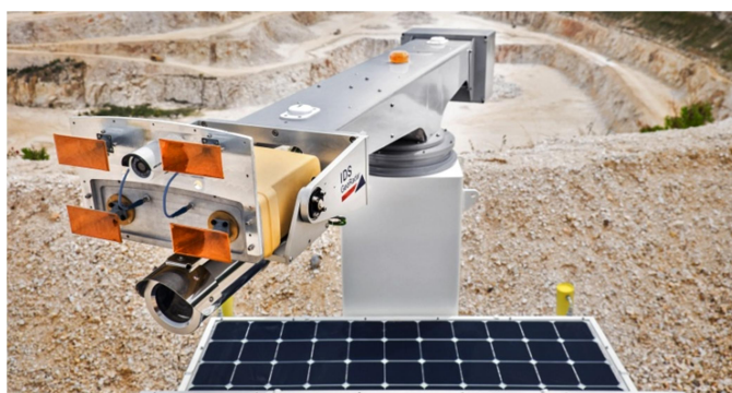
Rys. 7. Zdjęcie przykładowego radaru SAR produkcji IDS GeoRadar [12]
