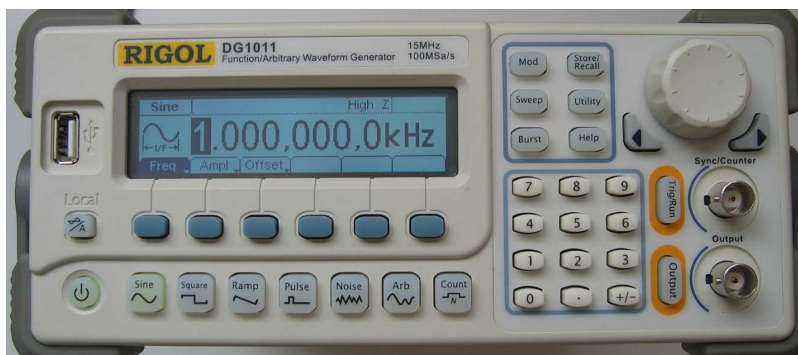
Rys.6. Płyta czołowa programowanego generatora funkcyjnego Rigol DG1011
